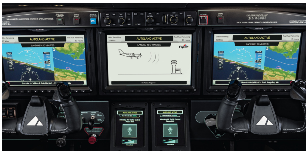
Fot. 2. Po uruchomieniu Autolandu na ekranach w kokpicie prezentowane są uproszczone informacje dla pasażerów, np. czas do lądowania. Źródło: Piper Aircraft.
