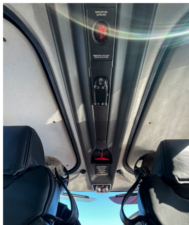
Fot. 4. Cirrus w modelu SR22 G7+ umieszcza przycisk do aktywowania Autolandu w suficie kabiny – tak by był on łatwo dostępny także dla pasażerów z tylnego rzędu. Źródło: Andrzej Rutkowski
