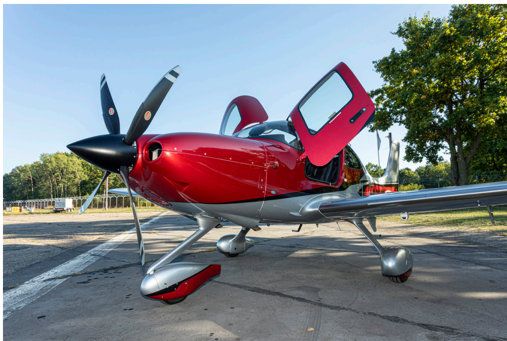
Fot. 3. Pierwszym samolotem o napędzie tłokowym wyposażonym w Autoland jest Cirrus SR22 generacji 7+. Zdjęcie wykonane na lotnisku Babice. Źródło: Andrzej Rutkowski
