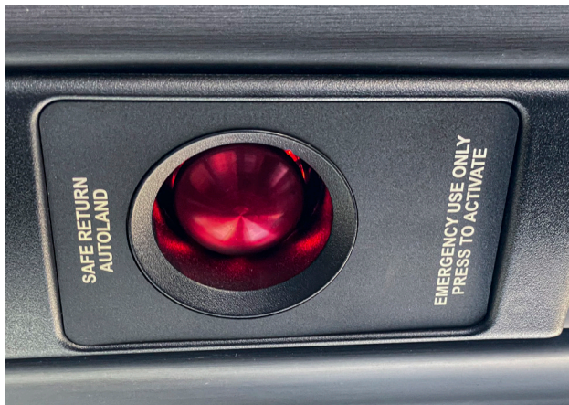
Fot. 4. Cirrus w modelu SR22 G7+ umieszcza przycisk do aktywowania Autolandu w suficie kabiny – tak by był on łatwo dostępny także dla pasażerów z tylnego rzędu. Źródło: Andrzej Rutkowski
