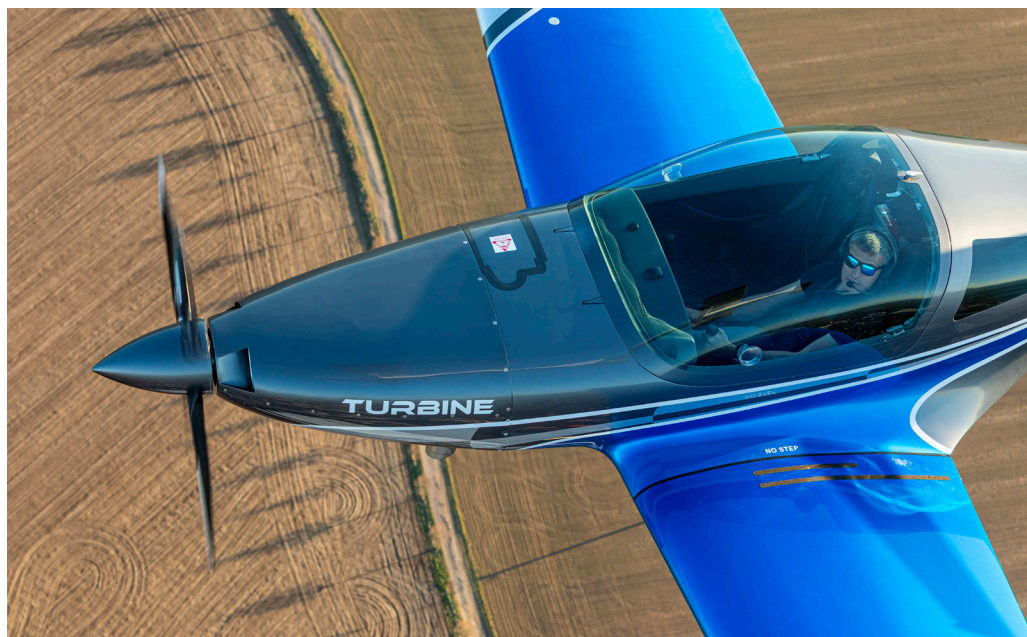
Fot. 7. W części samolotów ultralekkich spadochron zabudowany jest pomiędzy silnikiem a kabiną. Na zdjęciu VL-3 w wersji z napędem turbinowym. Fot.: Andrzej Rutkowski
