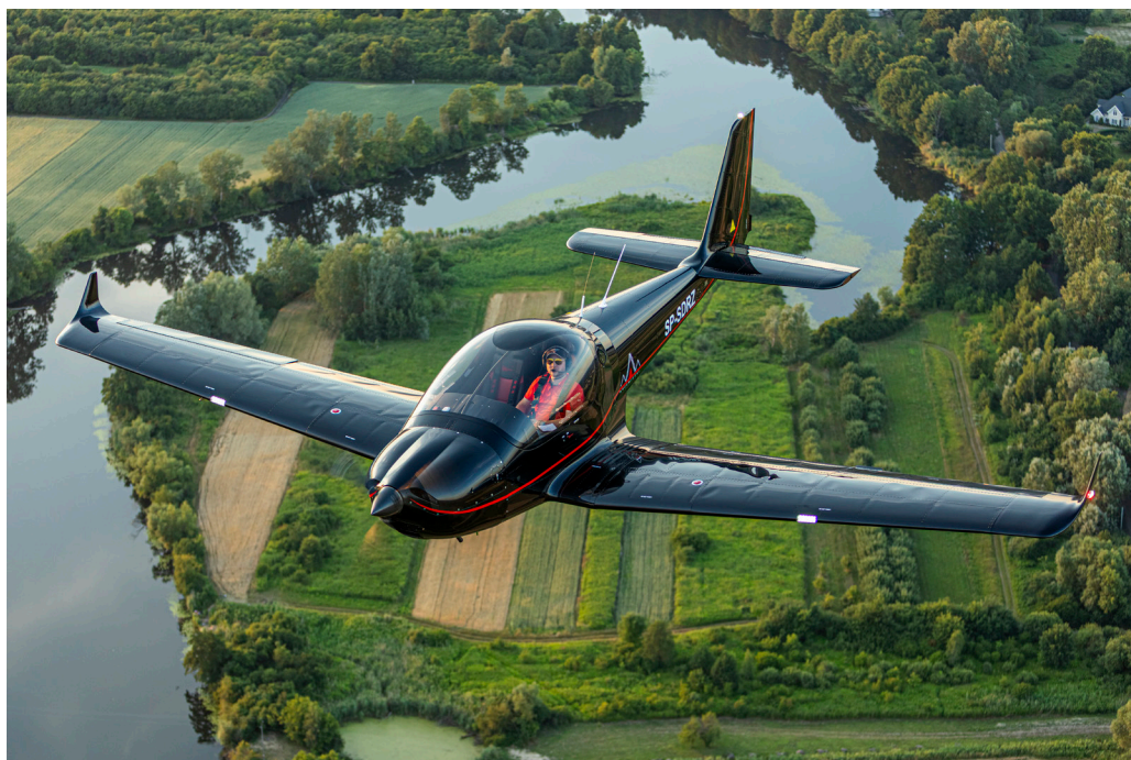
Fot. 9. Czeski Skylancer J600. Żółty trójkąt na ogonie to ostrzeżenie dla ratowników, że samolot ma spadochron z napędem pirotechnicznym. Fot.: Andrzej Rutkowski
