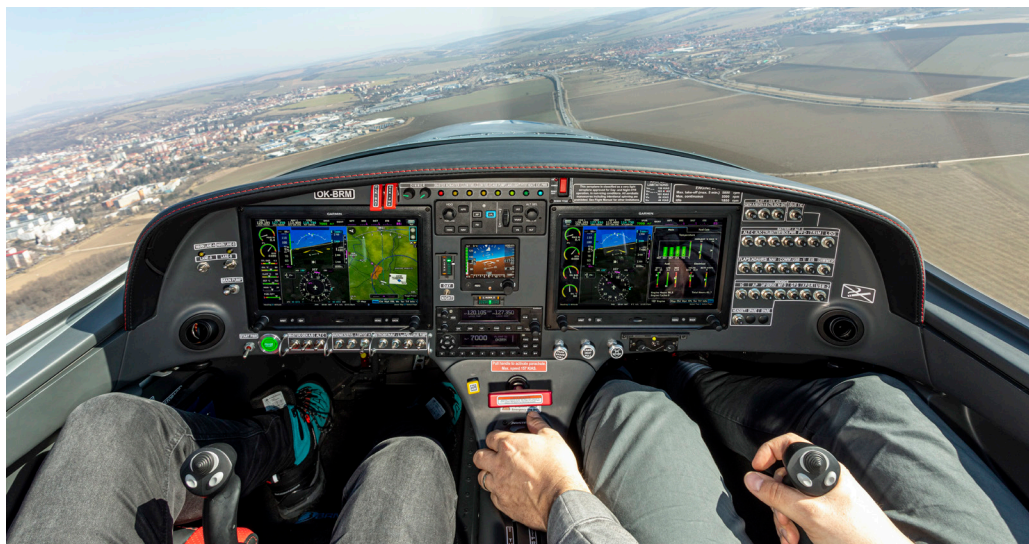
Fot. 6. Kabina samolotu Bristell BR23. Uchwyt wyzwalający spadochron zamontowany jest w środkowej, dolnej części tablicy przyrządów. Fot.: Andrzej Rutkowski
