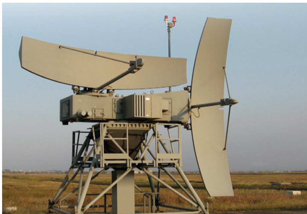
Fot.3. Radar precyzyjnego podejścia PAR, źródło: ze zbiorów autora
