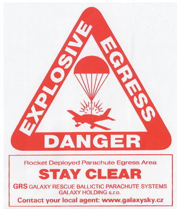
Fot. 4. W samolotach ultralekkich miejsce gdzie zamontowany jest spadochron jest oznaczone ostrzegawczymi nalepkami.. Źródło: Andrzej Rutkowski
