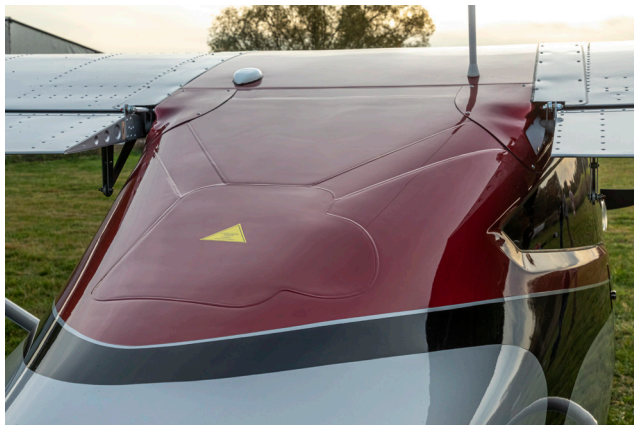
Fot. 4. W samolotach ultralekkich miejsce gdzie zamontowany jest spadochron jest oznaczone ostrzegawczymi nalepkami.. Źródło: Andrzej Rutkowski
